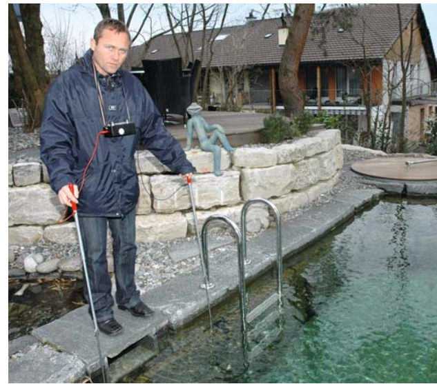
Gartenbauer André Dürig demonstriert die Lecksuche im Schwimmteich. Mit zwei Elektroden misst er den Stromfluss im Teichwasser.
